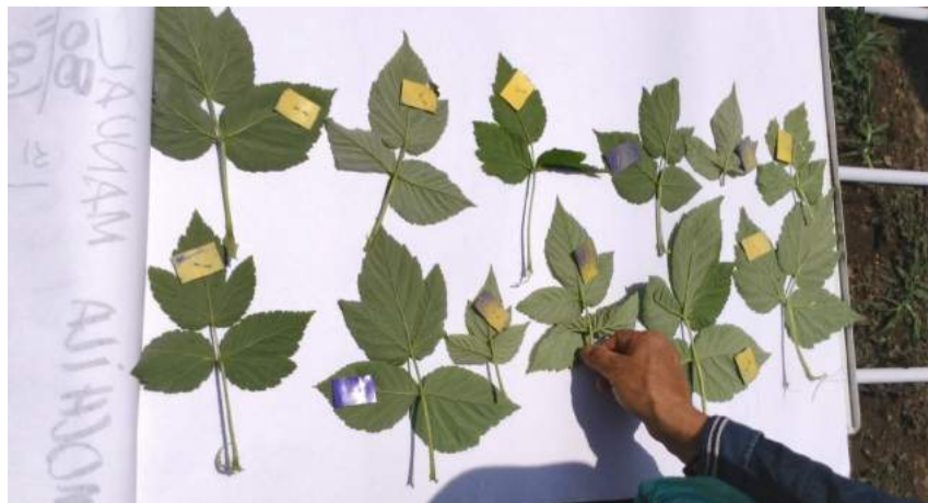
Figura 22. Calibración de Equipo mediante tarjetas hidrosensibles, resultados finales
